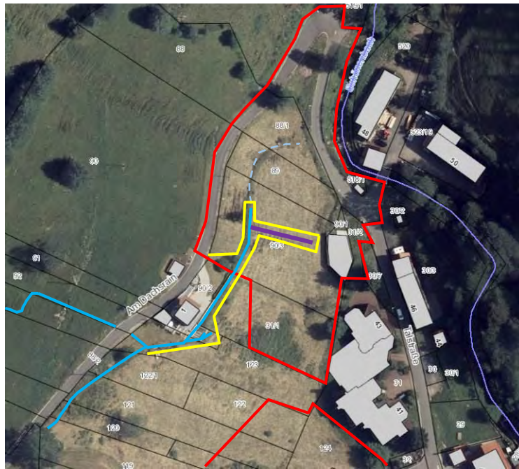
Abbildung 23: Darstellung des Plangebiets (rot), Schönenbach im Bild rechts dargestellt, Entwässerungsgraben (hellblau), Verlegung Entwässerungsgraben (hellblau gestrichelt entfällt, violett = neuer Abschnitt), Amphibien- und Reptilienschutzzäune nach Grabenverlegung (gelb).
