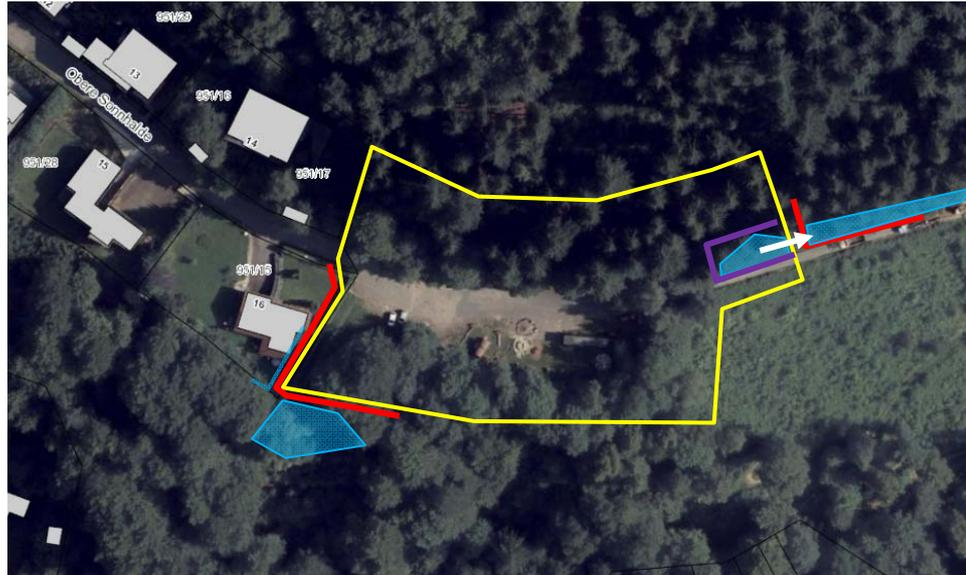
Abbildung 4: Plangebiet (gelb), Lage Felsen, Trockenmauern und Böschungen (blau); Lage Leitzäune (lila) und Vergrämuungsrichtung (weiße Pfeile); Position Schutzzäune während Bauarbeiten (rot)
