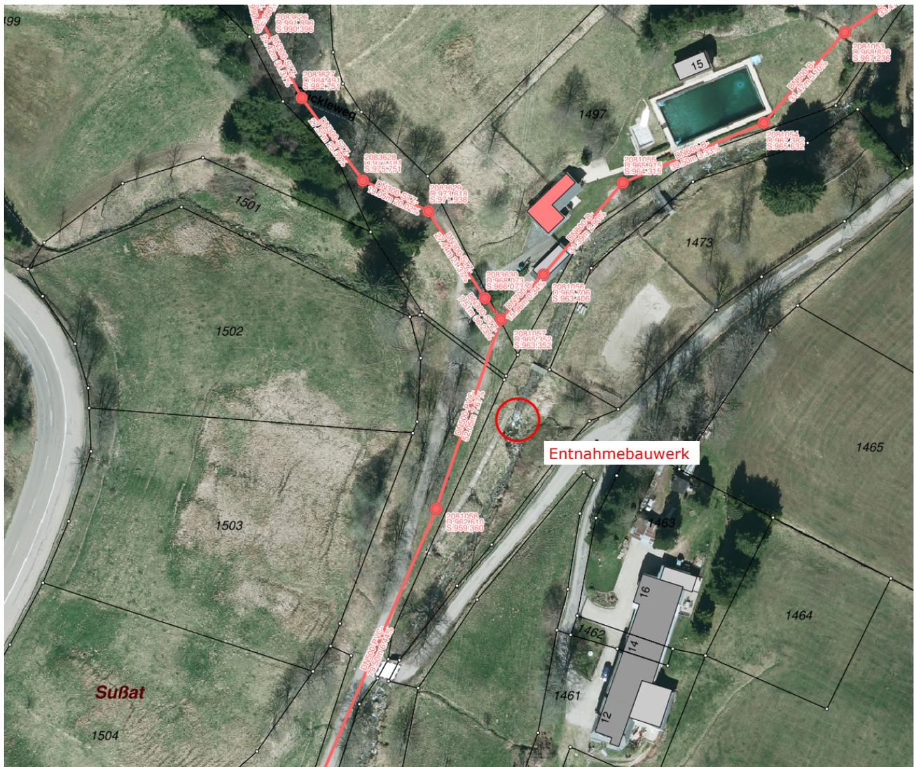
**Abbildung 3:** Verlauf des Schmutzwasserkanals im Bereich der Baumaßnahme
