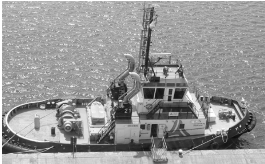
Methanol-betriebener Schlepper des Port of Antwerp (Bildquelle: ©Heinzmann GmbH & Co KG)
